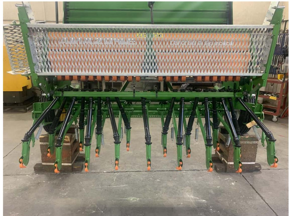
5. Suddividere e montare i tubi telescopici e rimontare le molle delle file.
