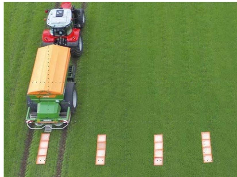
AMAZONE offre 2 sistemi per il controllo della distribuzione. Oltre al classico banco di prova mobile, è stato sviluppato il sistema EasyCheck per rendere rapida e semplice l'esecuzione di una registrazione e valutazione significative della distribuzione laterale.
