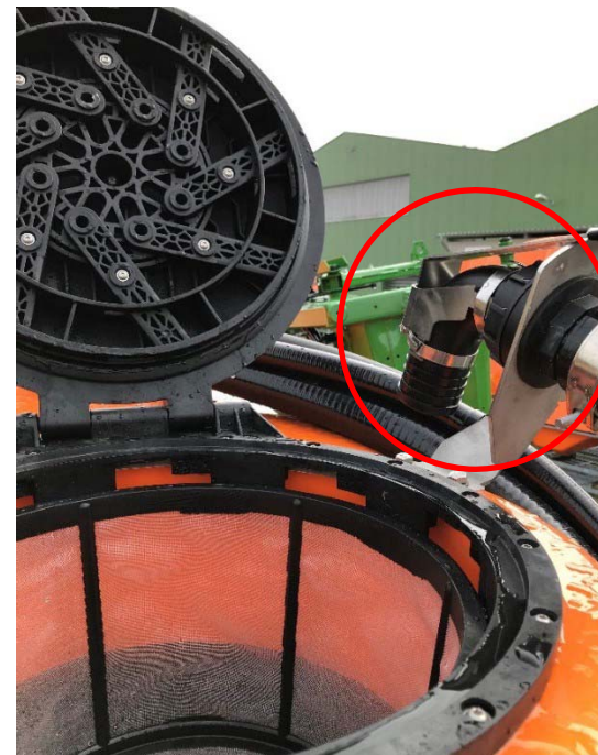
Dispositivo di riempimento con sezione a flusso libero
