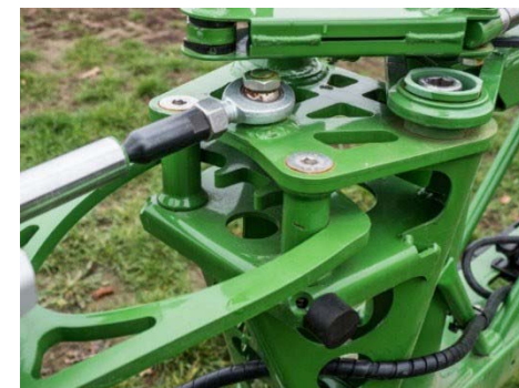
Giunto deflessione con cilindro idraulico
