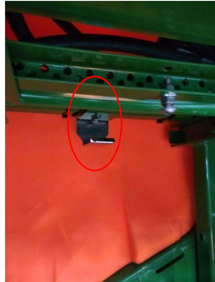
Bloccaggio automatico della scala quando chiusa
