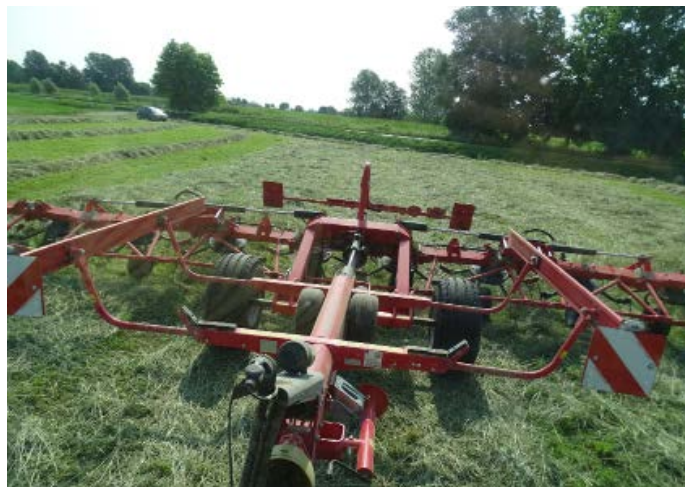
La stabilità durante il lavoro è assicurata dalle protezioni a rotaia unite
