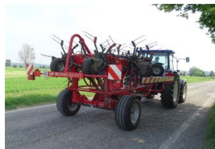
In modalità di trasporto lo Spider 1100 è largo 2,98 m, alto 2,45 m e lungo 5,10 m
