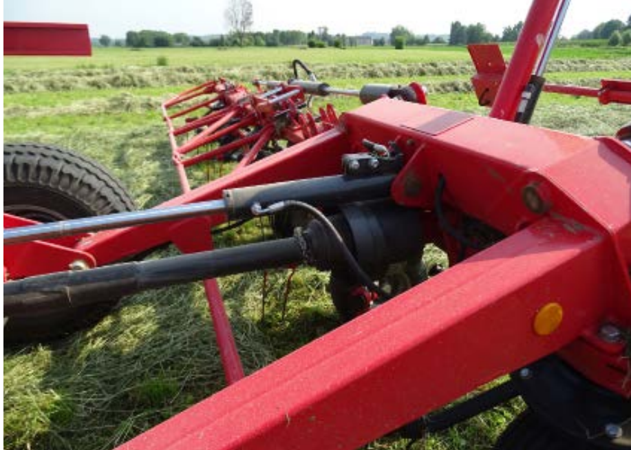
Sistema di alzata per facilitare e velocizzare apertura e chiusura per il trasporto
