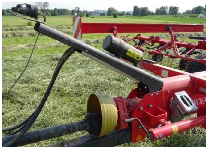
Timone regolabile per velocità fino a 40 km/h
