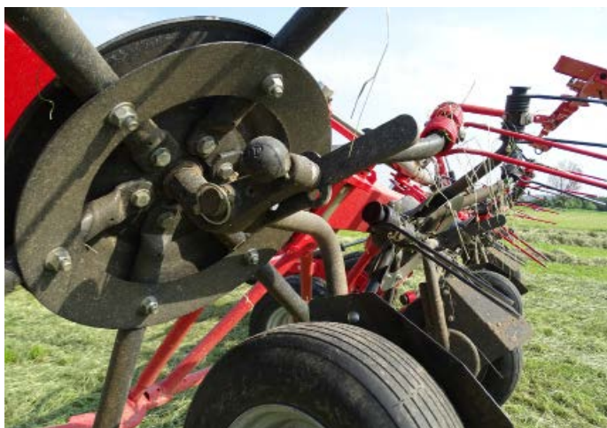
Le ruote possono essere regolate in altezza e angolo
