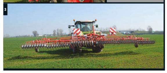
stati sostituiti da elementi stellari, composti da un disco di gomma in cui sono inserite aste in acciaio. Il suo nome è Aerostar Rotation e, a quanto ci dicono, suscita l'interesse di chiunque l'abbia visto lavorare o perlomeno ne abbia approfondito il funzionamento. Proprio quello che faremo anche noi, prima di raccontarvi l'esito del test in campo, realizzato in provincia di Rovigo su grano biologico.
