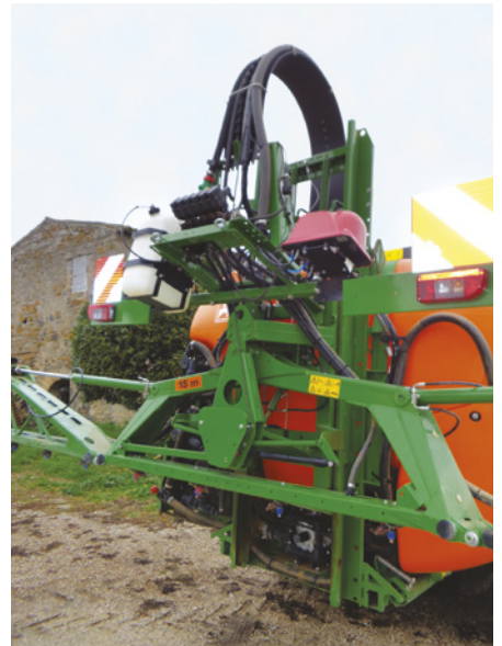
Il sistema di sollevamento innalza la barra fino a oltre 2 metri da terra
