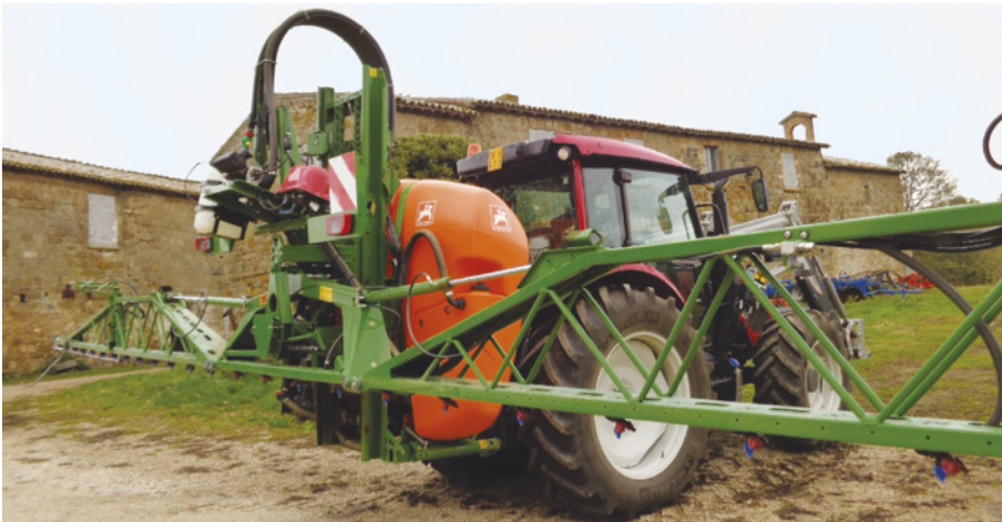
Sistema di chiusura verticale con martinetti idraulici
