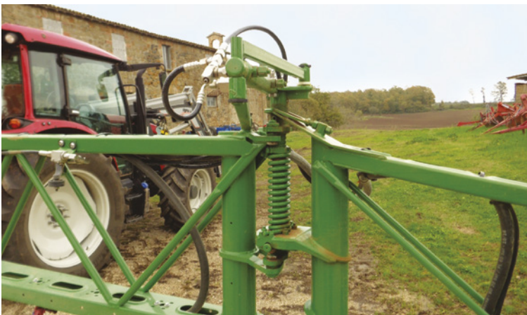
Molle di ammortamento negli snodi centrali della barra. Molto efficienti, secondo il proprietario
