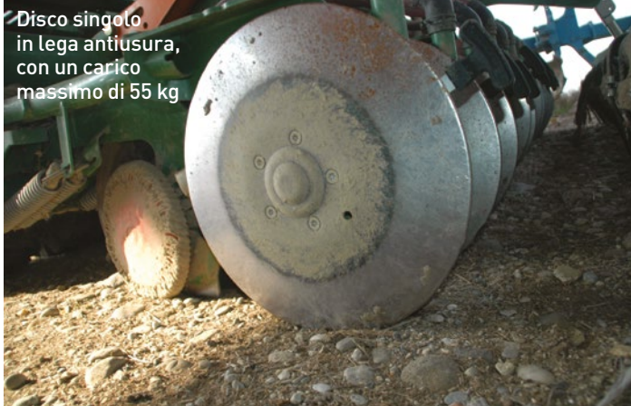
Il ruotino di profondità largo 2,5 cm assicura precisione anche su terreni soffici
