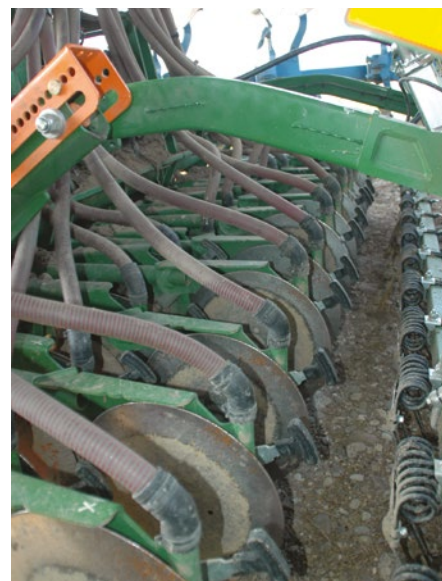
32 file con interlinea di 12,5 cm per la 4003 da 4 metri di larghezza
