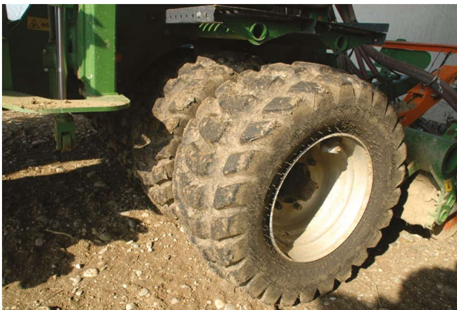
Rullo a ruote di tipo Matrix: compattano il suolo e lo preparano per la semina
