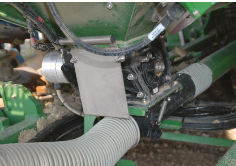
Dosatore elettrico, adatto sia alla chiusura delle sezioni per evitare sovrapposizioni sia al dosaggio variabile
