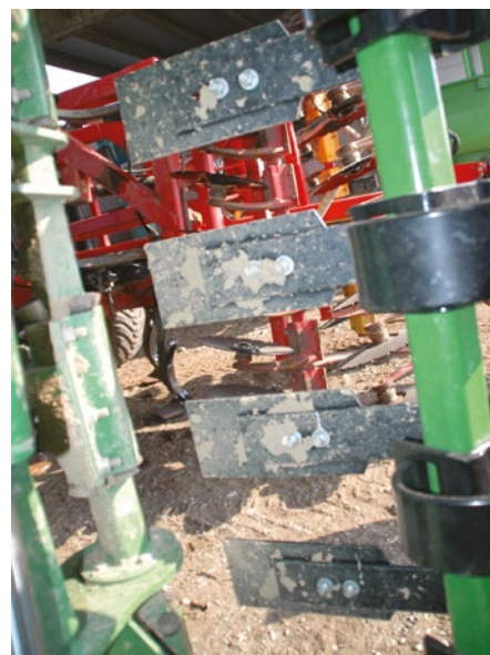
Una fila di palette - optional - livella il terreno prima del passaggio sotto il rullo a ruote Matrix
