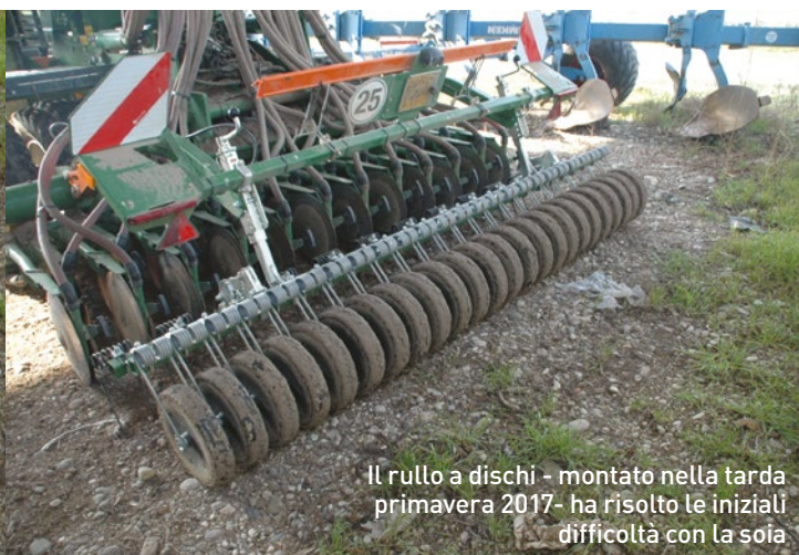
Il ruotino di profondità largo 2,5 cm assicura precisione anche su terreni soffici
