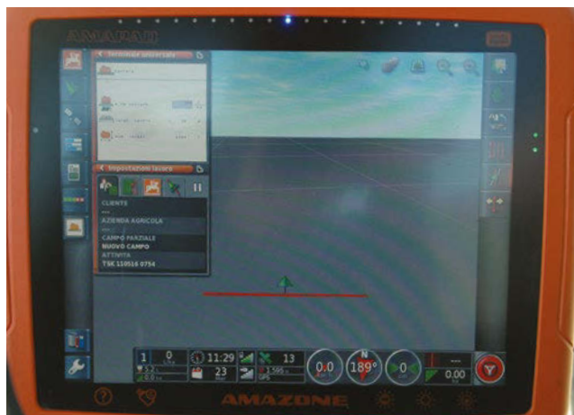
Monitor da 12 pollici per guida automatica e gestione dell'erogazione.
