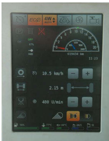
Un primo computer permette di gestire le funzioni del motore e trasmissione.
