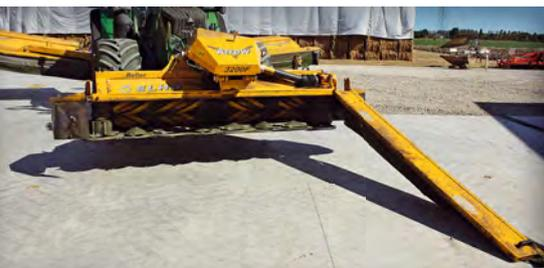
La frontale oltre all'HydroBalance sfrutta il **sistema di sospensione a pendolo a perno centrale (Pcs)**. L'agevole rimozione del carter protettivo anteriore permette di ispezionare rapidamente il sistema di taglio e condizionamento dell'unità frontale che, a livello di elementi di taglio e condizionamento, non differisce da quella posteriore: **8 dischi ciascuna con una coppia di coltelli a sezione ricurva e fissati tramite bullone**
