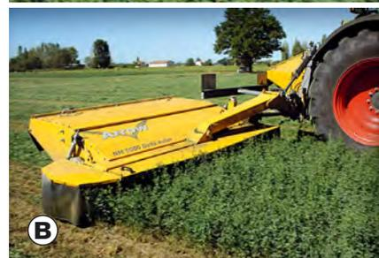
Il cantiere di sfalcio e condizionamento da noi testato era composto dalla frontale **Arrow 3200 Front Roller (A)** con larghezza di lavoro di 3,20 m e dalle due unità posteriori da 3 m ciascuna **NM 9000 Delta Roll (B)**
