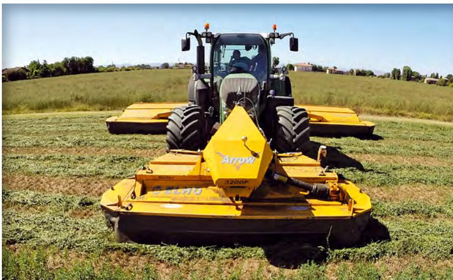
In fase di lavoro la **larghezza complessiva è di 9 m** mentre durante il trasporto **su strada l'operatrice mantiene l'ingombro nei 3 m** grazie al ripiegamento manuale di 180° delle bandelle laterali della FC anteriore e alla chiusura delle due unità posteriori verso l'alto di 90° per mezzo di due robusti martinetti idraulici
