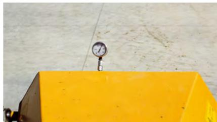
I manometri per il controllo della pressione di esercizio, dell'unità posteriore (sopra) e quella anteriore (sotto); in quest'ultima il manometro è risultato di **dimensioni troppo contenute** per la distanza in cui è stato posizionato rispetto all'operatore
