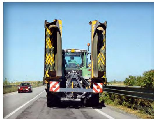
collegate al trattore dotato di atp di cat. III tramite un castello al quale sono incernierate. Un robusto martinetto idraulico per lato ne consente la posizione orizzontale di lavoro o il ripiegamento a 90° verso l'alto per i trasferimenti con una larghezza massima di ingombro di 3,0 m.
