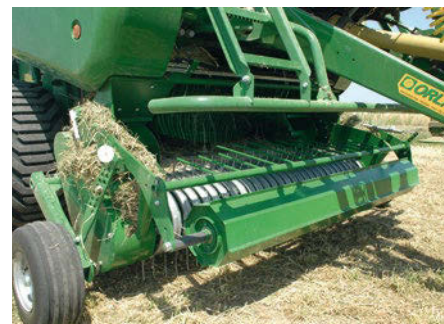
Pick up da due metri con cinque ordini di denti, efficace anche in caso di prodotto molto abbondante.
